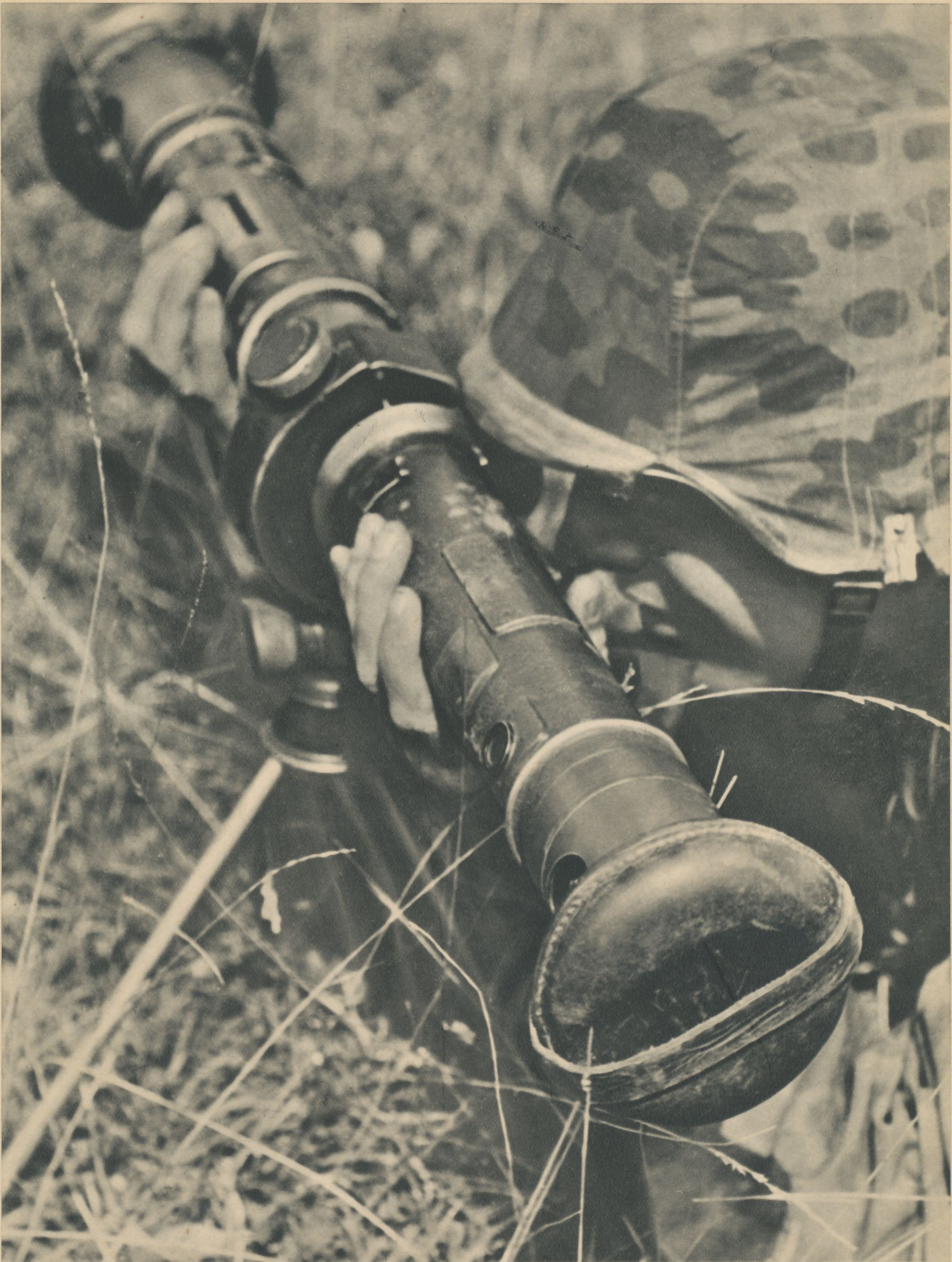
Vollkommen ruhig, trotz feindlichen Beschusses, stellt der Mann hinter seinem E-Messer die genauen Entfernungen fest, denn . . .
