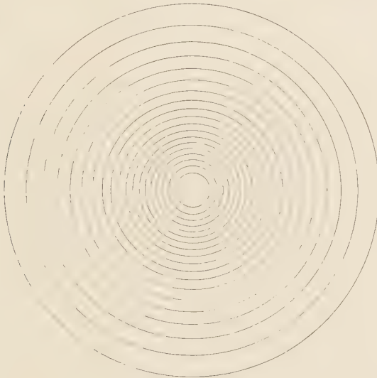
Abb. 34. Stromliniensystem aus der Umgebung eines Wirbels in der zähen Flüssigkeit.
