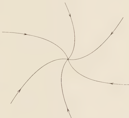
Abb. 37. Stromlinien einer einfachen Strudelströmung (Fall 1). \frac{4\nu t}{c^2} = 2 .
