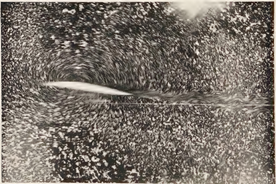
Abb. 96. Absolutströmung um ein Tragflügelprofil mit \alpha = 9^\circ . (Nach Ahlborn.)
