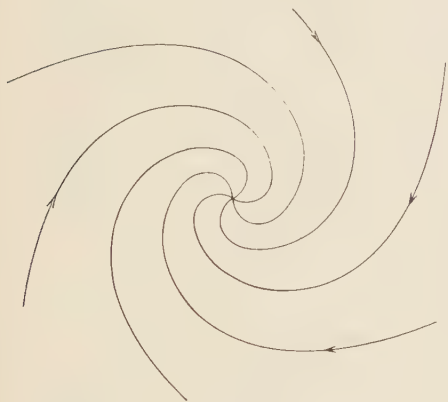
Abb. 35. Stromlinien einer einfachen Strudelströmung (Fall 1). \frac{4\nu t}{c^2} = 0,5 .
