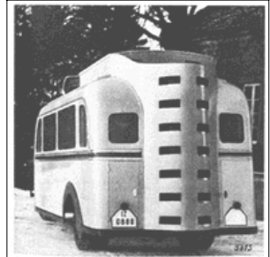
Bild 3. Omnibus mit 26 Sitzen und Holzgasantrieb. Besatz Prof. Dr. Döber. Die Generatoren im Heck erzeugen und vollständig zur Verfeuerung in der Verkleidung dienen zur Heiligung und sind gleichzeitig Synthesen für das Inducerepparat. Zusätzliches Holzgas wird beladet sich auf dem Becker Auslass über dem Dach. Fertigung der Teile und die Deckung der zu erwartenden Kraftstoffnachfrage.
