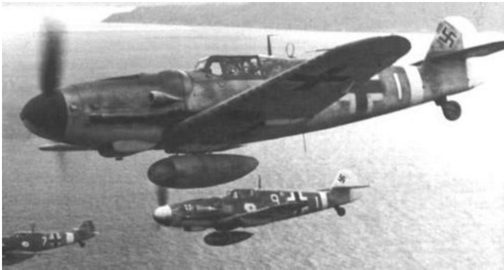
Messerschmitt 109: dos cañones, dos ametralladoras, 1700 caballos de fuerza; 600 kilómetros por hora. Junto con el Focke Wulff 190 en 1942 conservó el dominio del aire en Rusia.
