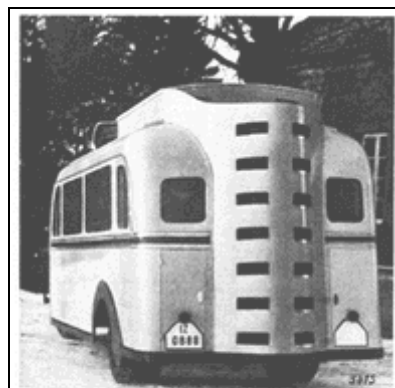
Bild 3. Omnibus mit 26 Sitzen und Holzgasantrieb. Bauert Prof. Dr. Dietrich. Der Generator ist im Heck angebracht und vollständig verkleidet. Die Lüftung im Heck dient zur Belüftung und sind gleichzeitig Stützpunkte für das Bodenpersonal. Zusätzlicher Holzvorrat befindet sich auf dem Dach über dem Heck. Fertigung der Teile und die Deckung der zu erwartenden Kraftstoffnachfrage.
