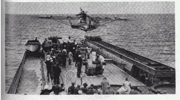
Abb. 48: Am 3. Februar 1934 hätte die Deutsche Luftbansa den planmäßigen Luftpostdienst nach Südamerika eröffnet. Der Südatlantik würde zwischen Batbursi/Westafrika und Natal/Brasilien mit dem Flugboot Dornier Wal »Tafiwur« überquert. Das Foto zeigt das Flugboot beim Start vom Katapult eines Stützpunktschiffes. Diese Technik war die Voraussetzung der Antarktisexpedition 1938.
