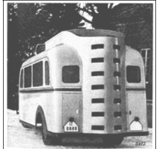
Bild 3. Omnibus mit 26 Sitzen und Holzgasantrieb. Besetzt Prof. Dr. Döberlein. Die Generatoren im Heck erzeugen Licht und vollständig von Kohlen. Die Luken in der Verkleidung dienen zur Belüftung und sind gleichzeitig Sauglöcher für das Induciergebläse. Zusätzlicher Heizwert befindet sich auf dem Heckes Auslass über dem Dach. Fertigung der Teile und die Deckung der zu erwartenden Kraftstoffnachfrage.
