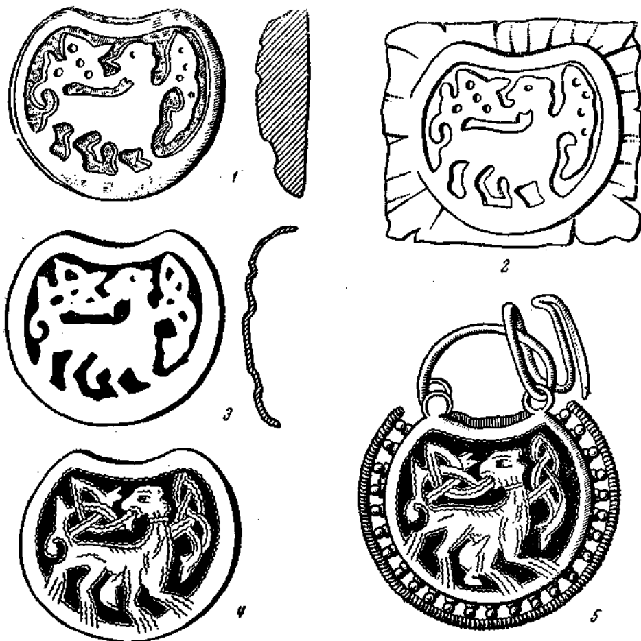
Рис. 84. Процесс изготовления серебряных колтов с чернью: 1 — медная матрица для штампования серебряных листов; 2 — тиснение серебряного листа на матрице; 3 — заливка углублений чернью и обжиг черни; 4 — зачистка черни и разделка контуров резцом; 5 — два щитка, спаянных вместе; по ребру напаяны шарики и проволока, приделаны петли и дужка (Святозерский клад, близ Чернигова).
