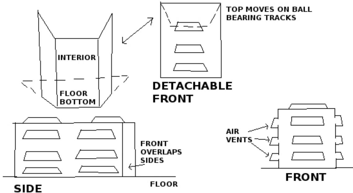
Клетки Фарадея могут ослаблять электромагнитную энергию. Стальной листовой металл, заземленный электрическим проводом, и ткань с 50% содержанием серебра могут составлять основную основу конструкции. Му-металл и кремниевая сталь могут быть добавлены в критических областях (область головы) для ослабления низких частот, которые являются вашим главным врагом.
